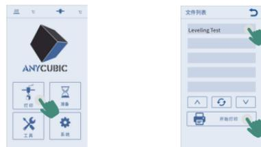
3) 喷嘴和热床升温至设定温度后，会打印简单模型来检测当前Z轴补偿值是否合适，请根具体现象微调Z轴补偿值，直到你见到耗材很好的黏在打印平台上，点击【确认】，测试完成。
