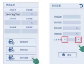
注：Z-Offset设置不正确会导致各种问题。如果喷嘴距离打印平台高度太高，您可能会面临打印件无法正确粘附的风险。另一方面，如果高度太低，您可能会遇到挤压问题和堵塞以及打印质量差，甚至会损坏打印平台。
