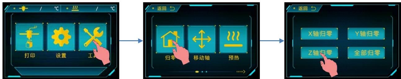
(2) 在打印平台上放一张纸（使用机器自带的调平纸）。用手移动打印头和打印平台至四个点（①→②→③→④）。依次在这四个点调节平台与喷嘴的距离，距离约为一张纸的厚度（0.1mm，抽动纸张有明显阻力）。
