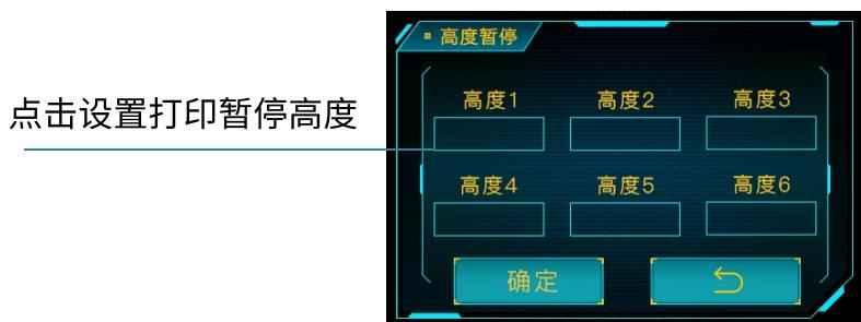
\* 按照“高度1”→“高度2”→……的顺序进行升序设置，最小值不能小于0.5mm，最大值不能超过205。
