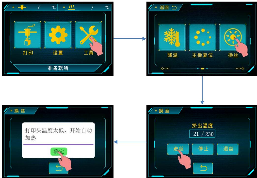
(2) 将耗材头部修剪整齐并掰直，将耗材卷放置在耗材支架上，耗材穿过断料检测模块。然后等待机器加热到目标温度。**(注意耗材出料方向)**
