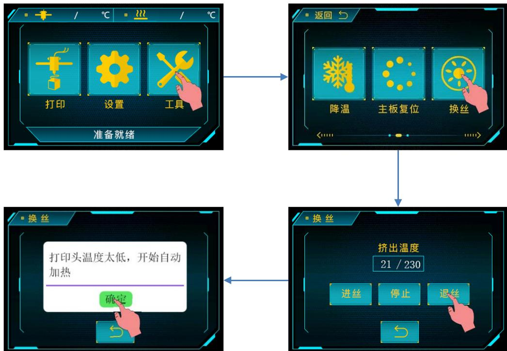
2、机器加热到目标温度后，再次点击“退丝”，此时挤出机将自动退料。待耗材退至挤出机齿轮处，手动将耗材拉出即可。
