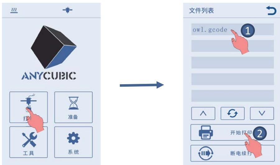
打印头喷嘴和热床升温到目标温度后，机器自动进入打印状态。（注：升温过程中，热床会先升温到目标温度，然后打印头才开始升温到目标温度。）
