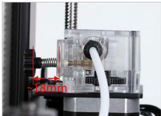
如右图所示，螺丝距离为18mm的，耗材出丝较均匀。可根据不同耗材出丝情况微调此距离。
