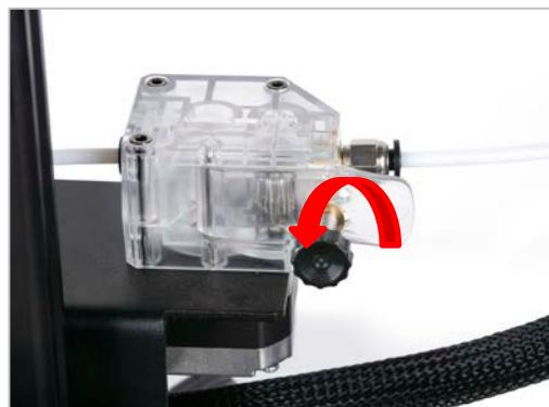
当出料较细或者出料断节时，如上图方向拧动螺母，减小挤出机的挤出力。
