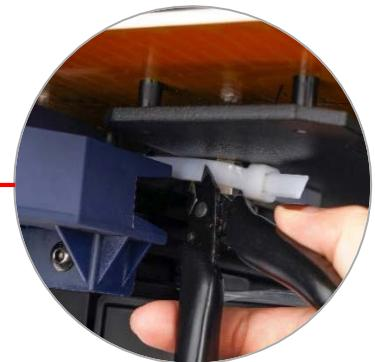
2. 机器因运输可能会造成底座D型轮松动的情况，请拆开包装后，把底座放置在一张平稳的水平桌上，摇晃打印平台，若打印平台会上下晃动，请锁紧平台下右侧D型滑轮的六角垫柱。
