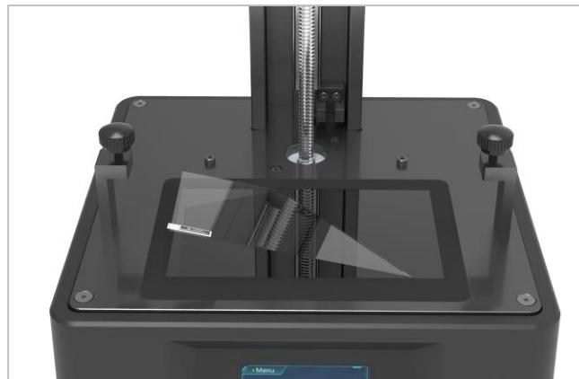
5、撕掉打印平台上的薄膜，拧松上方的4颗螺丝。
