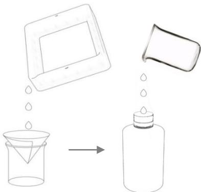
4、48小时内不使用机器时需将树脂倒回储存罐里(需过滤掉残渣)。
