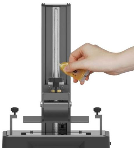
1、如Z轴工作中发出摩擦异响，请在Z轴丝杆上涂抹适量润滑油脂。
