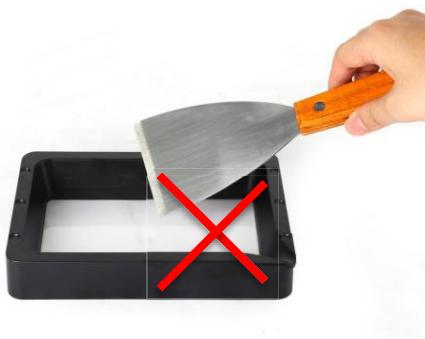
2、打印失败，清理残留在离型膜上的树脂：全屏曝光20s，再将固化的树脂整层揭下，可以有效保护离型膜。
