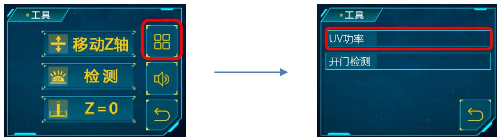
或者，在打印过程中，点击“模型打印”界面的“齿轮”图标。在“打印设置”中向下翻页，找到“UV功率”，点击并设置相应参数。
