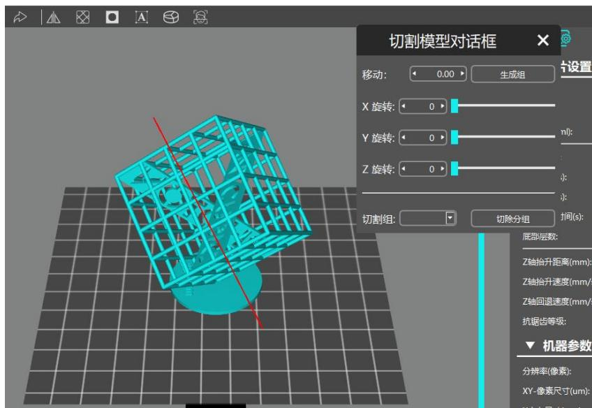
拉动滑块可对切割面进行XYZ轴旋转，然后点击“生成组”。
