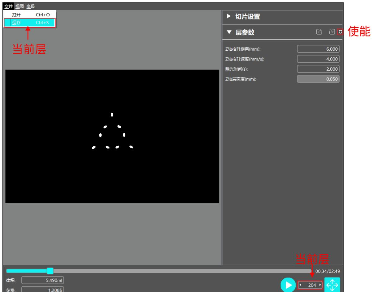
注意：设置层参数后，新文件打印过程中不能再对曝光参数进行修改，若不慎修改，也仅对当前层有效，下一层曝光参数与文件设置的参数保持一致。
