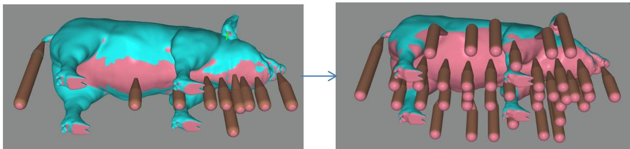
技巧二：手动支撑辅助添加。利用等高线寻找最低点，等高线圈最小位置即为局部最优点，需要添加支撑。
