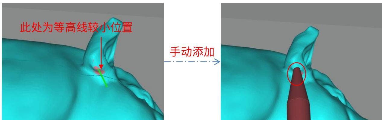
技巧三：检测悬岛。手动或自动添加支撑后，可利用检测悬岛功能检测模型是否有其他需要添加支撑的部分。点击“视图”→“2D视图”和“视图”→“检测悬岛”，拉动滑块查看每层切片后的图像。
