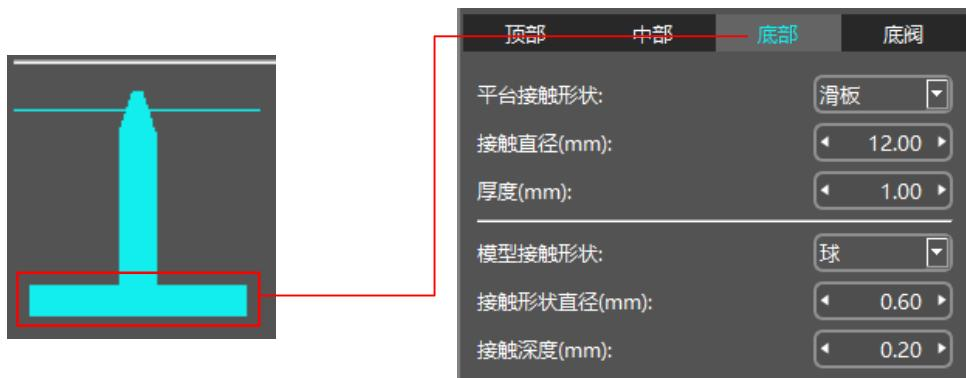
平台接触形状: 建议使用“滑板”作为底部, 便于将模型从平台铲下。
