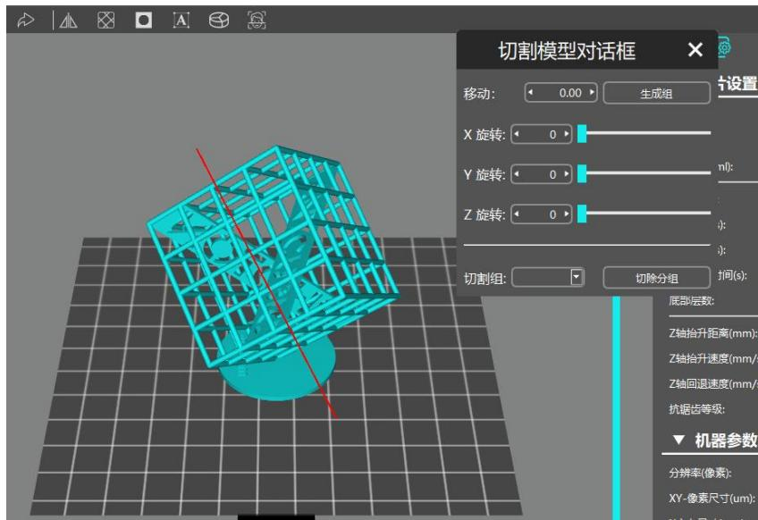
拉动滑块可对切割面进行XYZ轴旋转，然后点击“生成组”。
