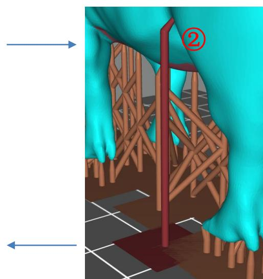
编辑：点击“编辑”按钮切换到编辑状态，对支撑的形状和位置进行修改。
