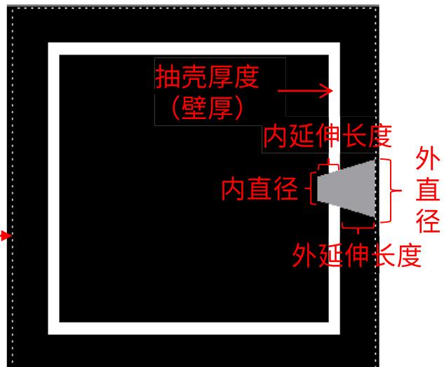
“内延伸长度”必须大于“抽壳厚度”，打孔时才能打穿模型，树脂才能从模型内部流出来。
