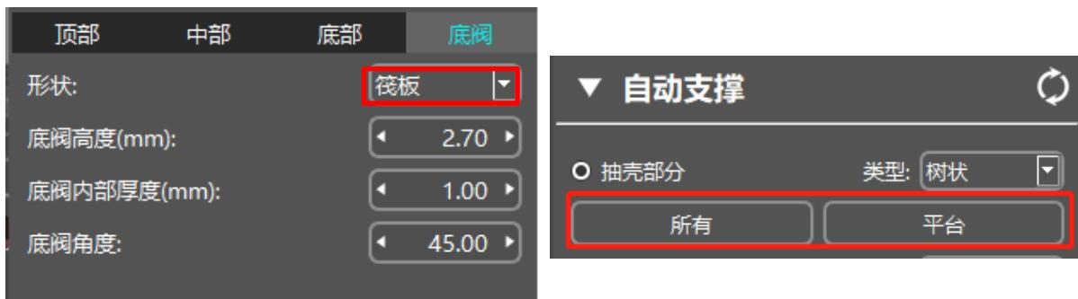
注意: 添加底阀前, 需先将模型在Z轴方向上抬升一定高度。
