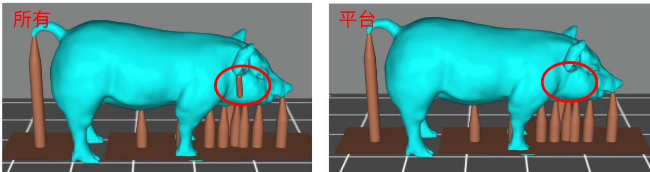
温馨提示：使用自动支撑模式，将覆盖所有已添加的支撑。
