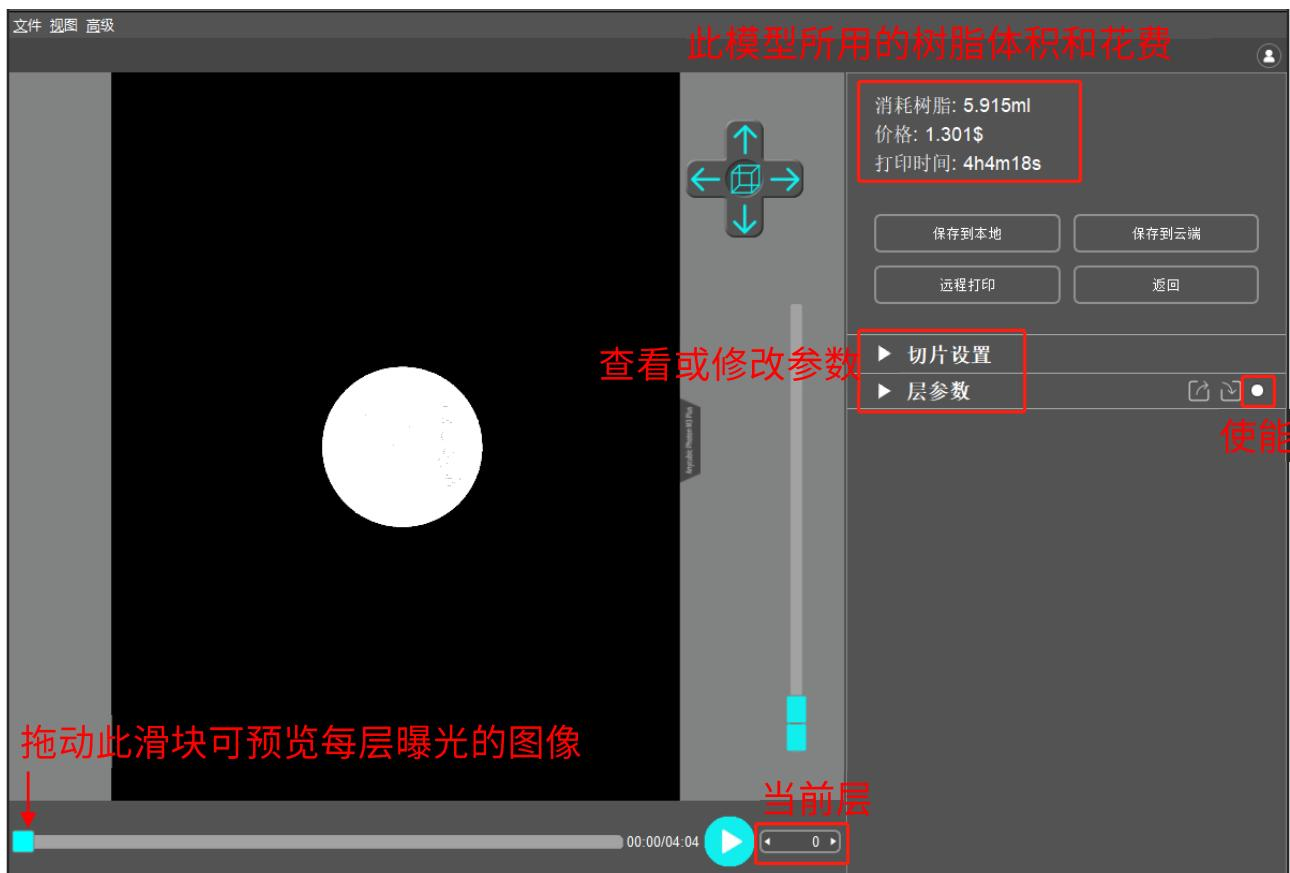
注意：设置层参数后，新文件打印过程中不能再对曝光参数进行修改，若不慎修改，也仅对当前层有效，下一层曝光参数与文件设置的参数保持一致。
