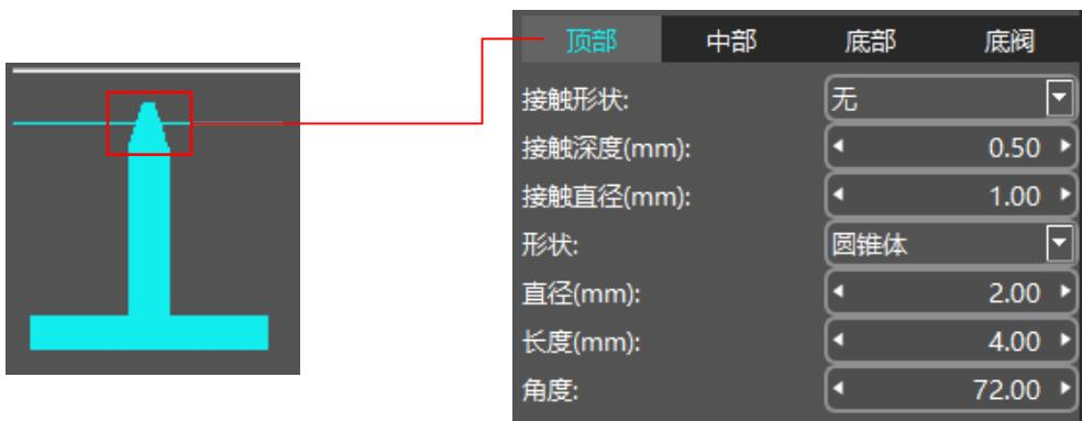
**接触形状：**选择“球”作为顶部和模型的接触点，可以加大支撑和模型之间的接触面。接触直径仅当形状为“球”时有效。
