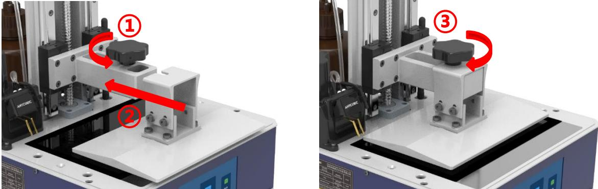
13、在固化屏上放一张专用调平纸（随机器配送）, 点击操作屏上的“
