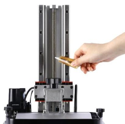
1、如Z轴工作过程中发出摩擦异响，请在Z轴丝杆上涂抹适量润滑油脂。
