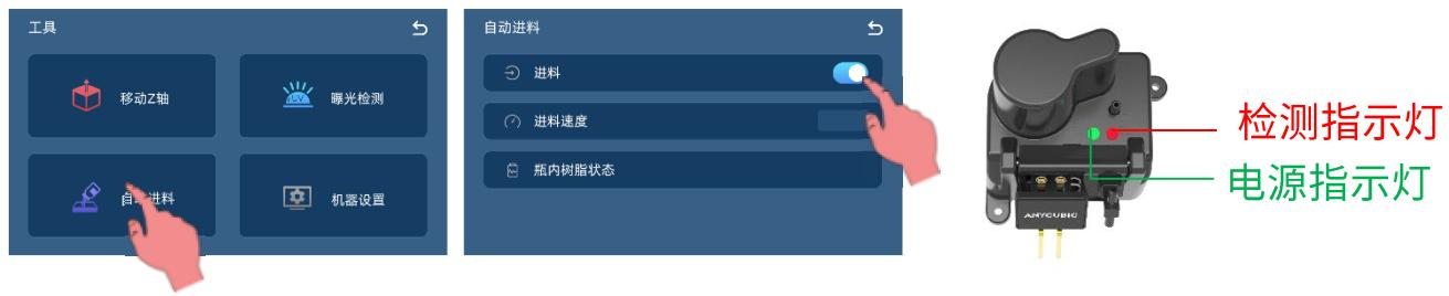
打印时，若检测到树脂瓶内余量不足，机器将发出蜂鸣声提示补充树脂，并关闭自动进料功能。如需继续使用自动进料功能，请及时补充树脂，再点击打印界面对应的按钮开启自动进料。
