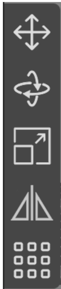
点击“移动”图标，在该窗口设置或操作模型上的控件移动模型。还可以对模型进行“居中”“放置平台”操作。
