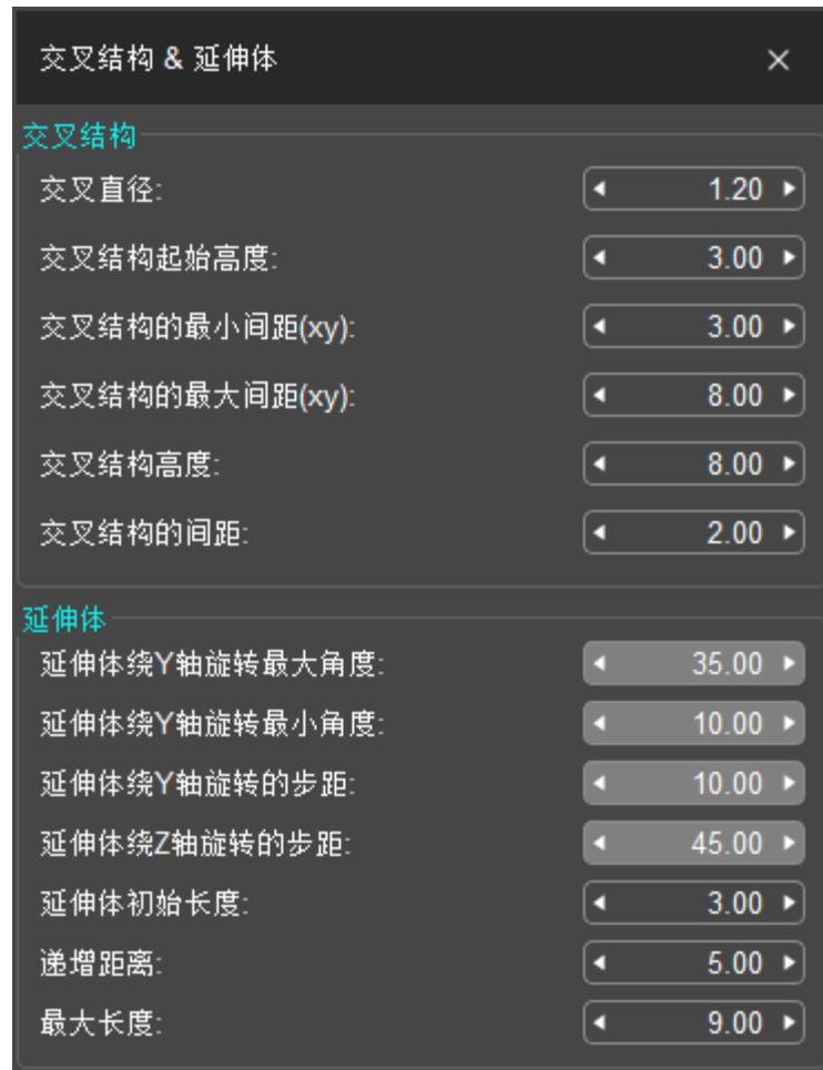
**交叉结构：**支撑之间需要添加横向的交叉结构，用于增加支撑之间的结构强度，使支撑更牢固、稳定。
