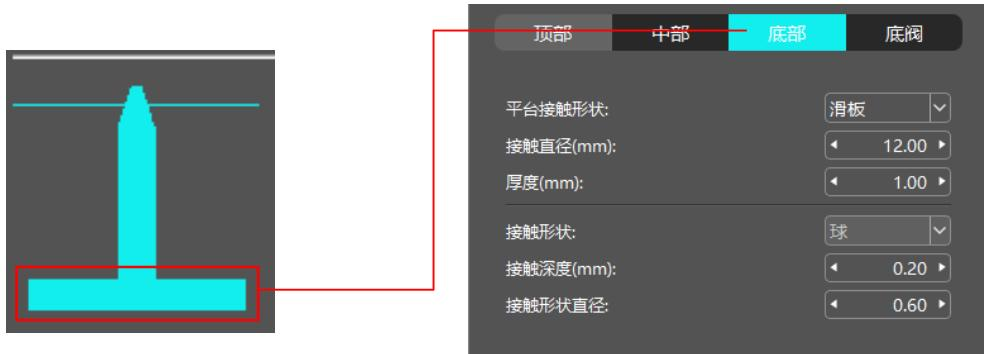
**平台接触形状：**建议使用“滑板”作为底部，便于将模型从平台铲下。
