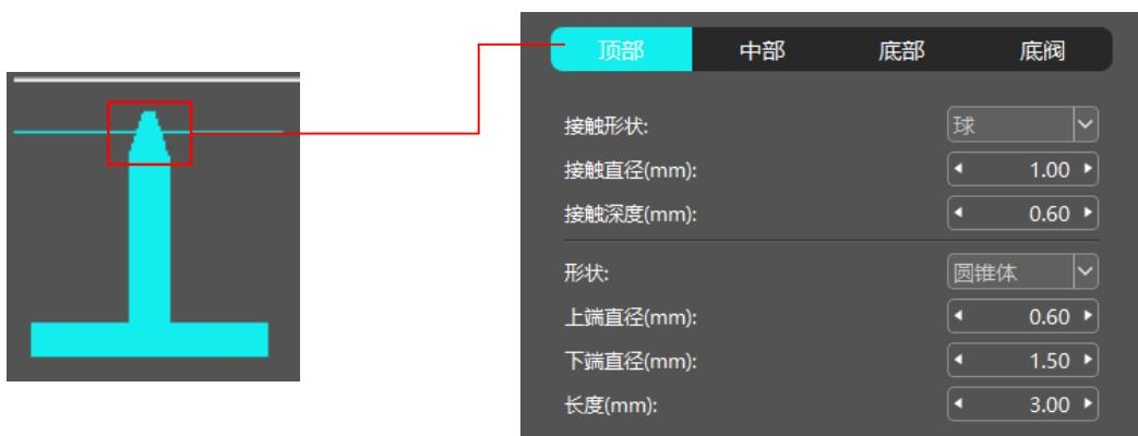
**接触形状:** 接触形状为“球”可以加大支撑和模型之间的接触面。
