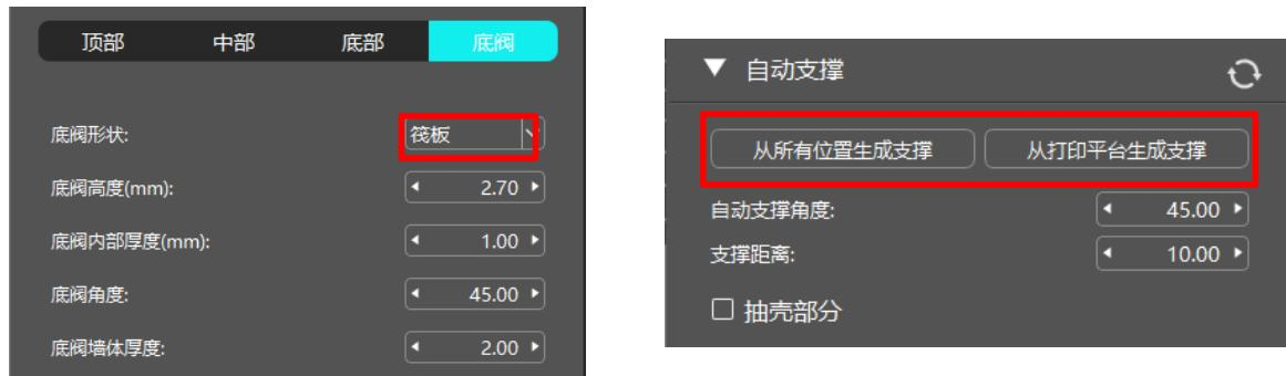
**注意：**添加底阀前，需先将模型在Z轴方向上抬升一定高度。
