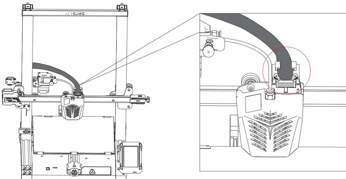
8. 用线扣将打印头线束和铁氟龙管捆绑在一起
