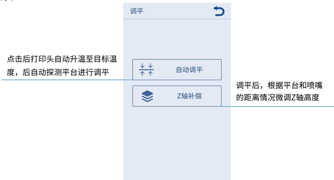
**注：一般情况下，自动调平后无需再进行“Z轴补偿”微调Z轴。**
