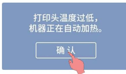
3. 查看屏幕上的温度显示，待机器加热到目标温度后，再次点击“退丝”，打印头会先挤出部分耗材，然后再进行退丝。待耗材退至挤出机处时（即耗材停止退出），请及时将耗材取出，避免打印头冷却后造成堵料。若无法取出耗材，请手动按压挤出机手柄，然后快速拔出耗材。最后，点击屏幕上的“停止”按钮。
