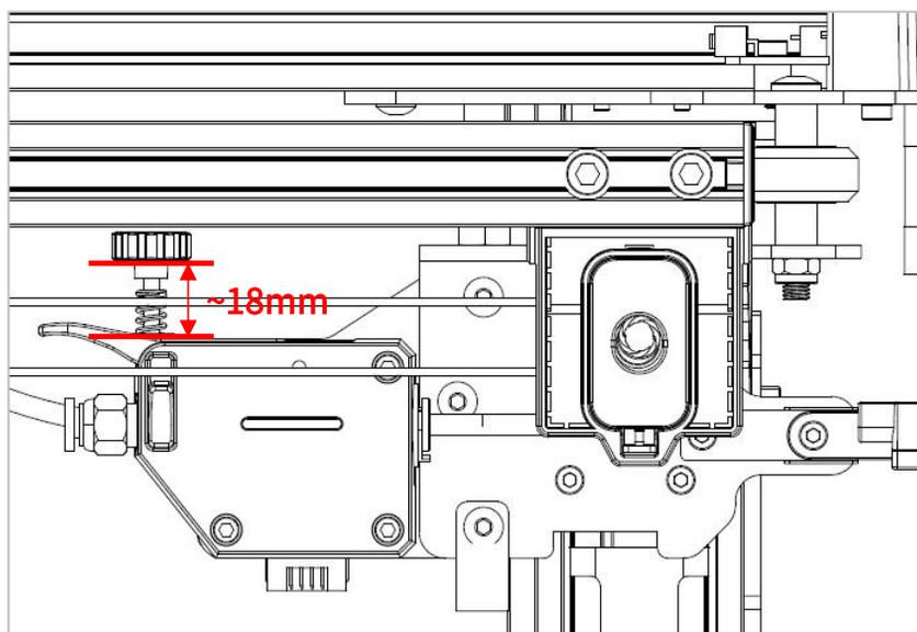
如上图所示，螺丝距离为18mm的，耗材出丝较均匀。可根据不同耗材出丝情况微调此距离。
