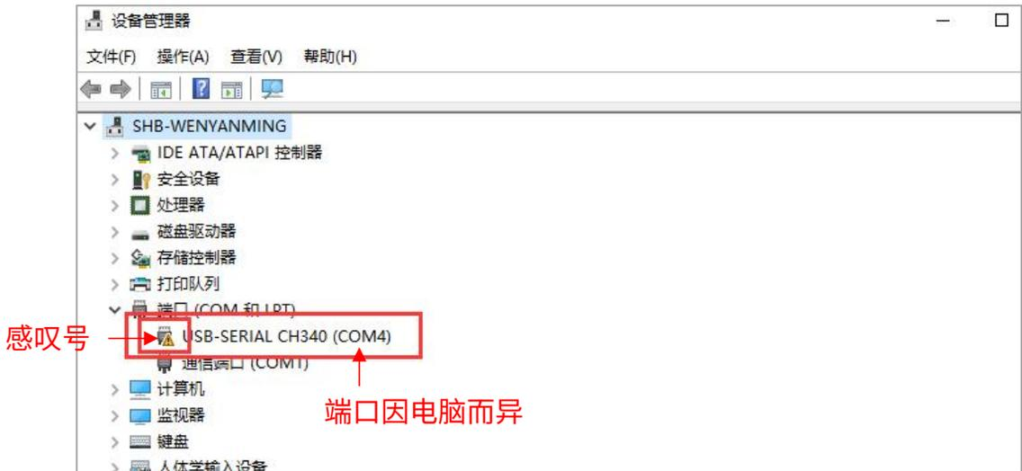
(2) 双击存储卡中的“CH341SerSetup.exe”，按照安装向导手动安装驱动程序。若步骤 (1) 已自动安装，请忽略此步骤。
