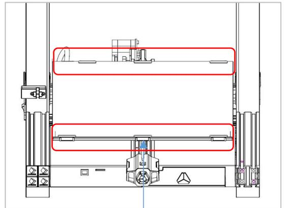
用6个夹子将晶格玻璃固定在平台上。
