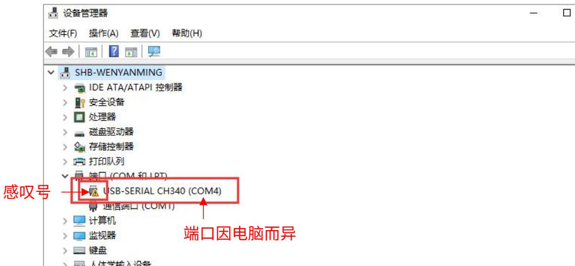
(2) 双击存储卡中的“CH341SerSetup.exe”，按照安装向导手动安装驱动软件。若步骤(1)已自动安装，请忽略此步骤。
