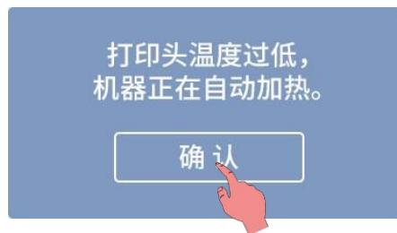
3. 查看屏幕上的温度显示，待机器加热到目标温度后，再次点击“退丝”，打印头会先挤出部分耗材，然后再进行退丝。**待耗材退至挤出机处时（即耗材停止退出），请及时将耗材取出，避免打印头冷却后造成堵料。若无法取出耗材，请手动按压挤出机手柄，然后快速拔出耗材。**最后，点击屏幕上的“停止”按钮。
