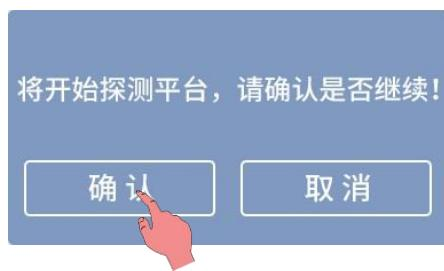
4. 等待机器完成自动探测后，取一张纸放置于喷嘴下方。点击 Z轴补偿 → + 或 - 不断调整 Z 轴高度，直至喷嘴触碰到纸张（拉动纸张时感受到**轻微阻力**），最后点击**确认**，调平完成。
