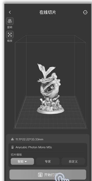
① 打印开始前，打印机将会检查关键硬件设备、树脂量和调平状态，确保打印可以正常进行。若检测过程发现异常，机器将自动报错，请根据机器报错的指引，扫描二维码。
