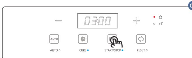
3. 固化过程中, 如果需要开门, 请按下START/STOP键, 机门状态显示解锁时即可打开。
