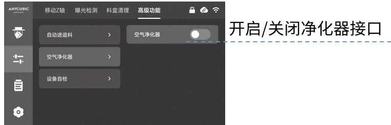
开启空气净化器接口，则自动进退料模块连接失效。如需使用自动进退料功能，请先关闭空气净化器连接。
