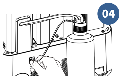
将瓶盖检测线接入 打印机背面接口
